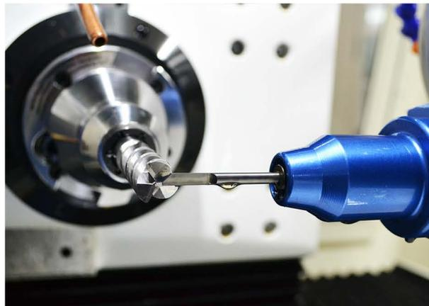
通过软件选装包，GIVEALGRIND系列机床还能实现刀具生产过程中的自动误差补偿功能，机床能根据加工后自动测量的数据结果对加工偏差进行自动修正，是无人值守量化生产的上佳选择。
